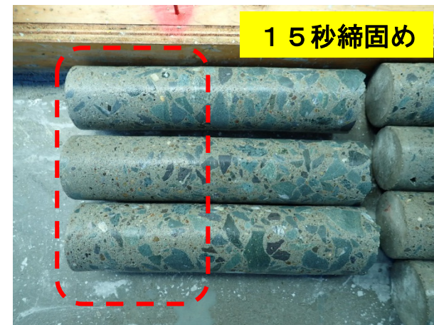
粗骨材の沈下が確認される
